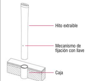
• **Caja** de acero galvanizado para embutir en solera.
